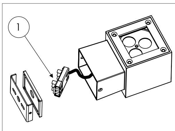
**B.** Alimentate il proiettore utilizzando il morsetto “1”.
