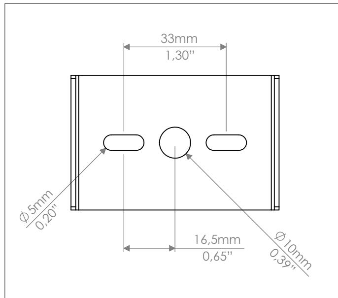
Utilizzare le due asole Ø 5 per fissare la piastra di fissaggio.
