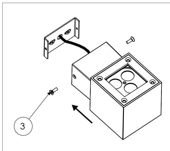
Fissate il proiettore alla piastra utilizzando le due viti “3”.
