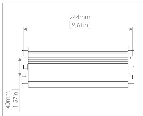
Utilizzare i quattro fori Ø4 (0.15") sulla scatola per fissare l'apparecchiatura.
